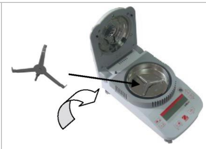
(2) Installez le support du plateau, tournez jusqu'à ce qu'il s'engage pour se mettre en place
