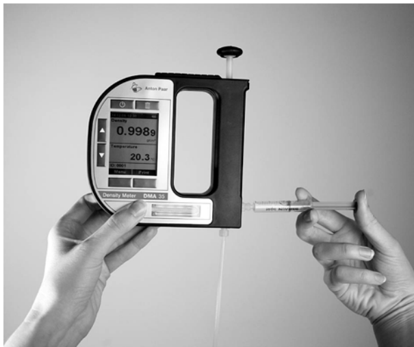
Abb. 10 - 2 Probe mithilfe einer Spritze einfüllen
