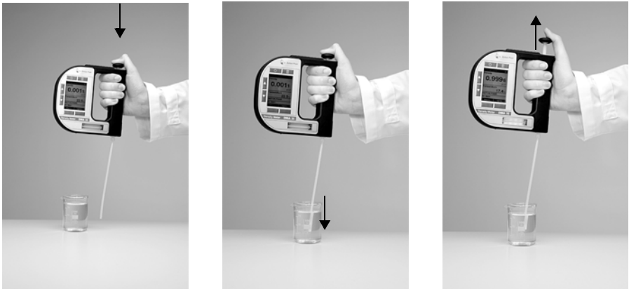
Abb. 10 - 1 Probe über das Saugrohr einfüllen
