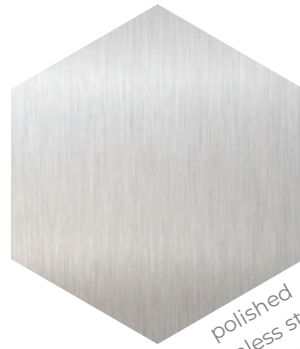
stainless steel to DIN 1.4016 (AISI 430)
